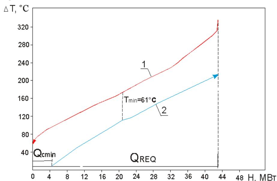
Рис. 4. Составные кривые сдвинуты к  $\Delta T_{\min} = 61^\circ\text{C}$
