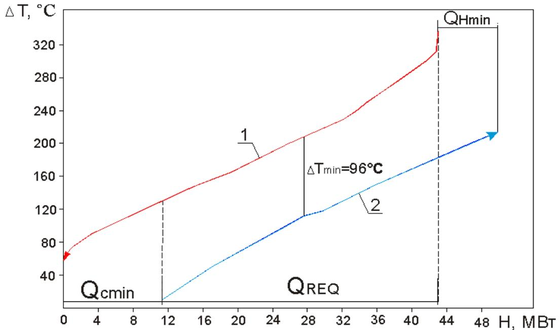
Рис. 3. Составные кривые существующего процесса переработки нефти
